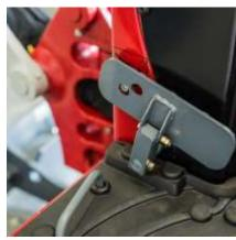
Doppia asola per posizione di riposo e posizione attiva, per il comando di attrezzature ad azionamento manuale.
