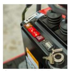
Contaore e spie di allarme Per refrigerante, pressione olio motore, carica batteria e seconda velocità di traslazione.
