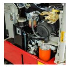
Vano laterale Punto di accesso al tappo di rabbocco gasolio e filtri motore.
